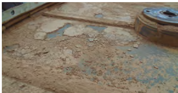
Figure 7.7. Terre entre la plaque sauve-banc et la plaque d'éjection due à la rupture du soufflet
