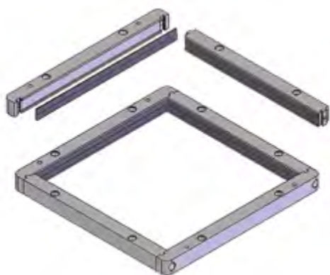
Figure 3.34. Schéma d'une plaque en carbure de tungstène insérée dans une barrette et assemblage des barrettes renforcées
