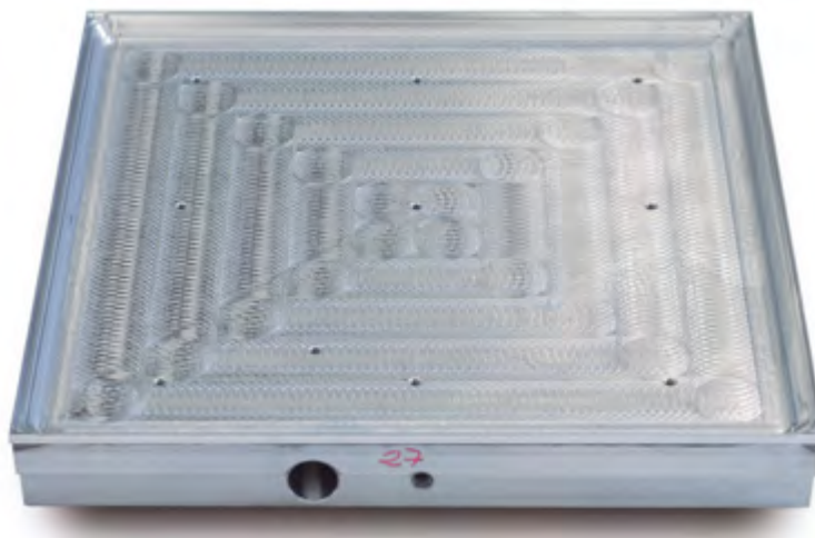
Figure 3.44. Poinçon isostatique à cavité unique
