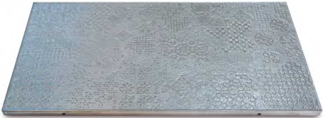
Figure 3.36. Poinçon pour les carreaux grand format (60x120 cm) en relief
