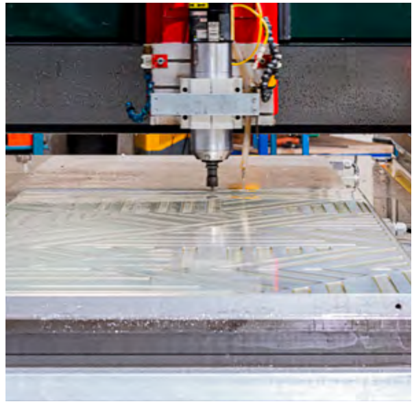
Figure 2.30. Usinage du relief avec une fraiseuse sur une empreinte en aluminium
