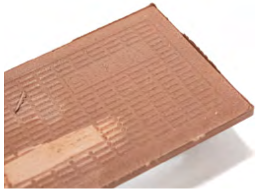
Figure 7.10. Ébarbures sur la face du relief de dos
