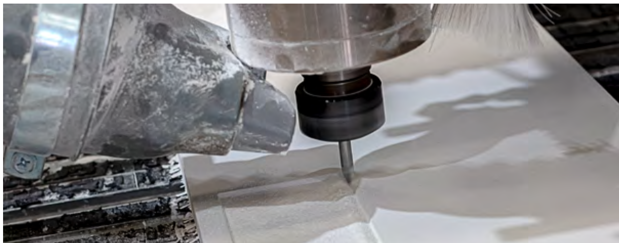
Figure 2.25. Fraiseuse à commande numérique pour prototypes en plâtre
