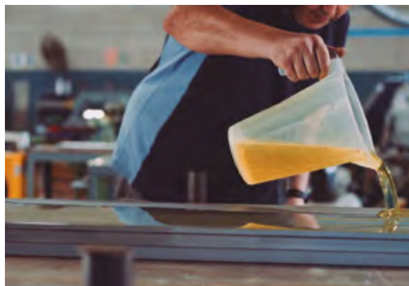
Figure 4.40. Versement du caoutchouc liquide dans un poinçon
