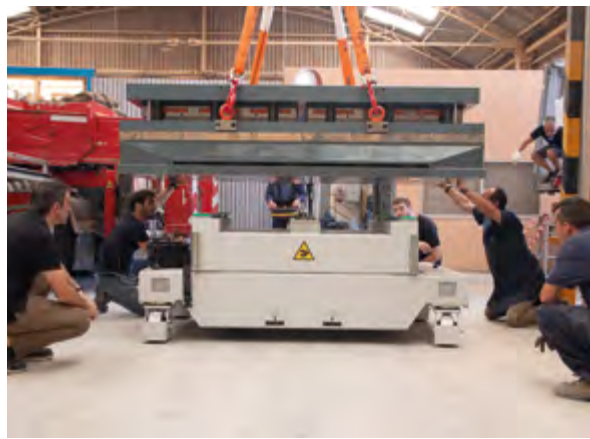
Figure 6.15. Transport du moule pour installation ou remplacement
