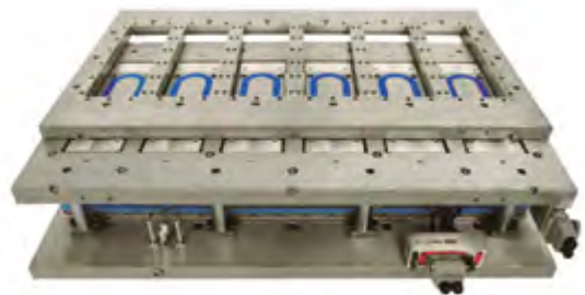
Figure 5.5. Moule pénétrant à matrice interchangeable
