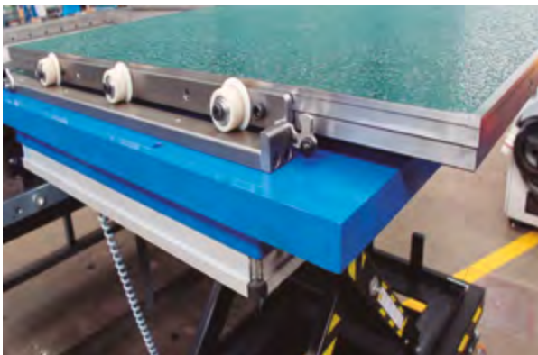
Figure 6.10. Système de poinçons coulissants
