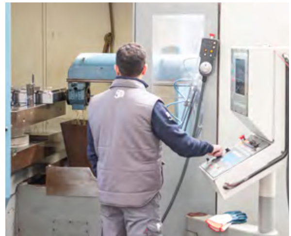
Figure 4.9. Perçage de la plaque sauve-banc à l'aide d'une perceuse à commande numérique
