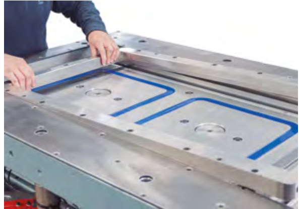
Figure 6.9. Changement de barrettes hors de la presse
