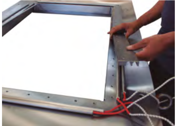
Figure 3.63. Résistances chauffantes périmétriques en forme de L
