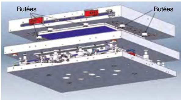
Figure 5.19. Moule à miroir pénétrant avec butées
