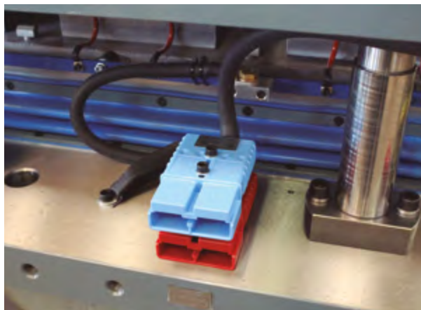
Figure 3.65. Connecteurs rapides dans la partie inférieure du moule
