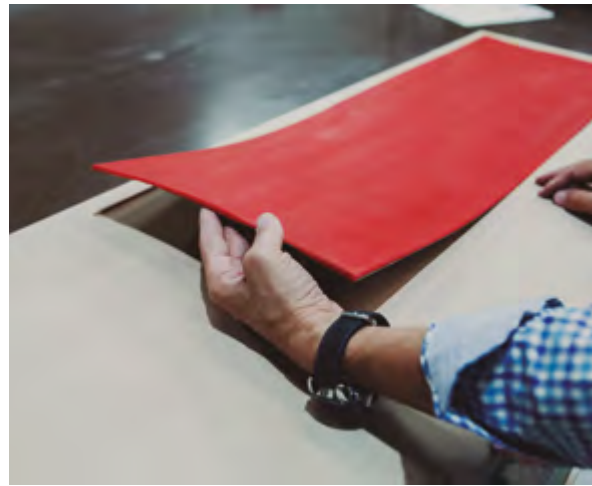
Figure 4.5. Caoutchouc pour poinçons en feuille
