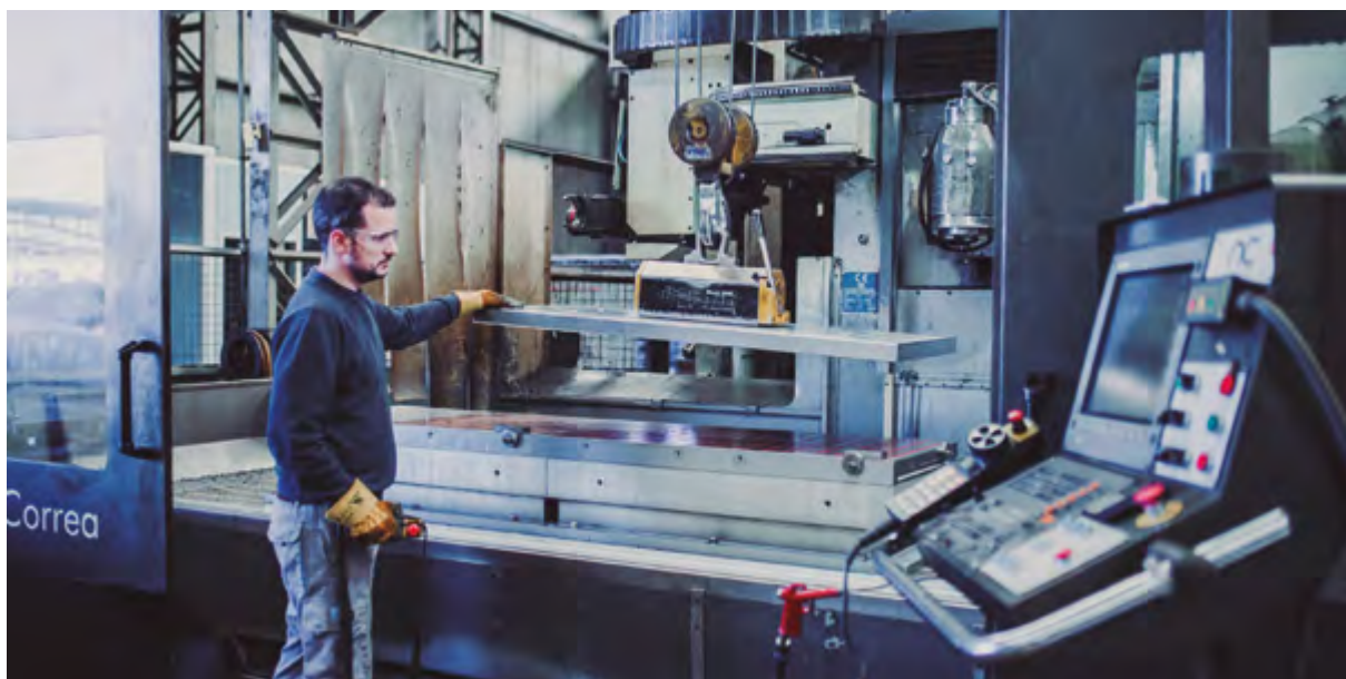
Figure 6.12. Levage et manutention de charges importantes à l'aide de palans et d'aimants
