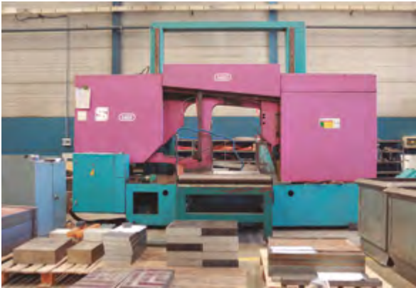
Figure 4.33. Découpe des plaques d’acier brut par sciage
