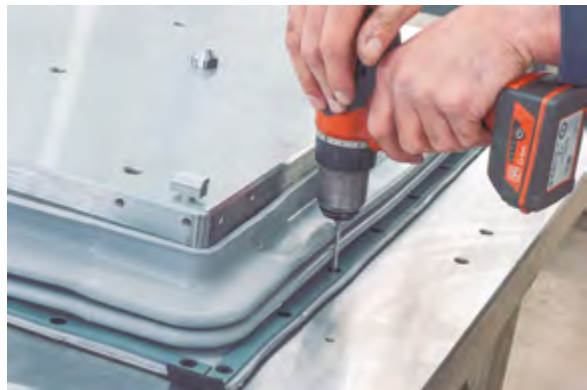
Figure 3.18. Montage du soufflet en silicone
