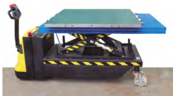
Figure 6.14. Chariot hydraulique manuel pour le changement des poinçons
