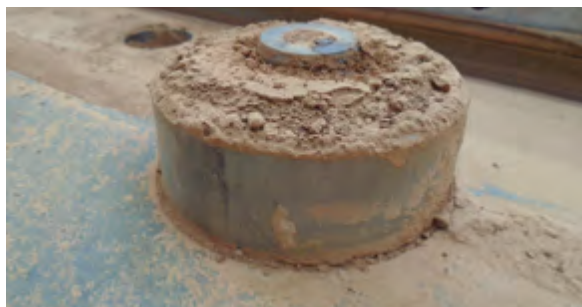
Figure 7.7. Terre entre la plaque sauve-banc et la plaque d'éjection due à la rupture du soufflet
