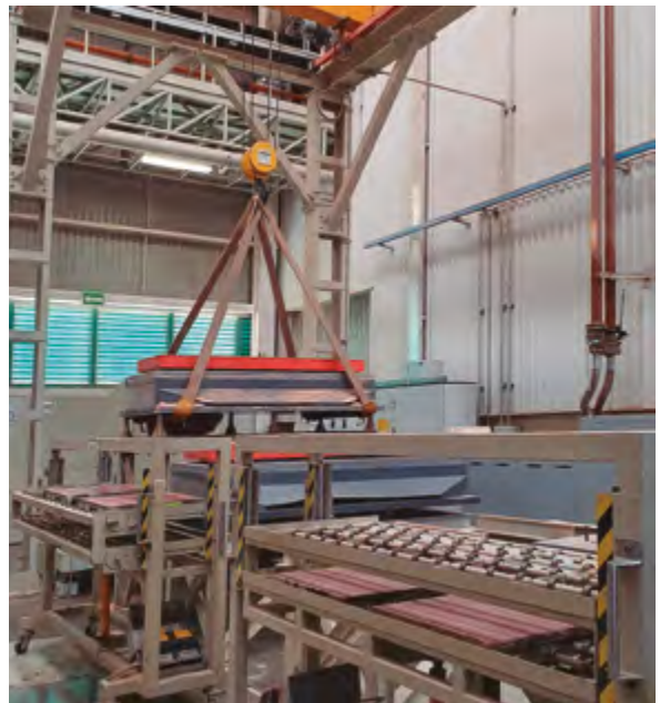
Figure 6.4. Déplacement et stockage des moules et des composants
