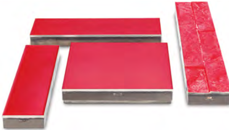
Figure 3.39. Poinçons avec revêtement en caoutchouc
