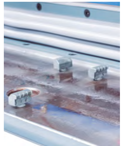
Figure 3.16. Disposition des souffleurs sur le périmètre de la plaque sauve-banc
