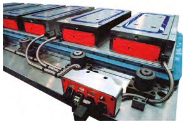
Figure 5.24. Moule alimenté à 380-440 V
