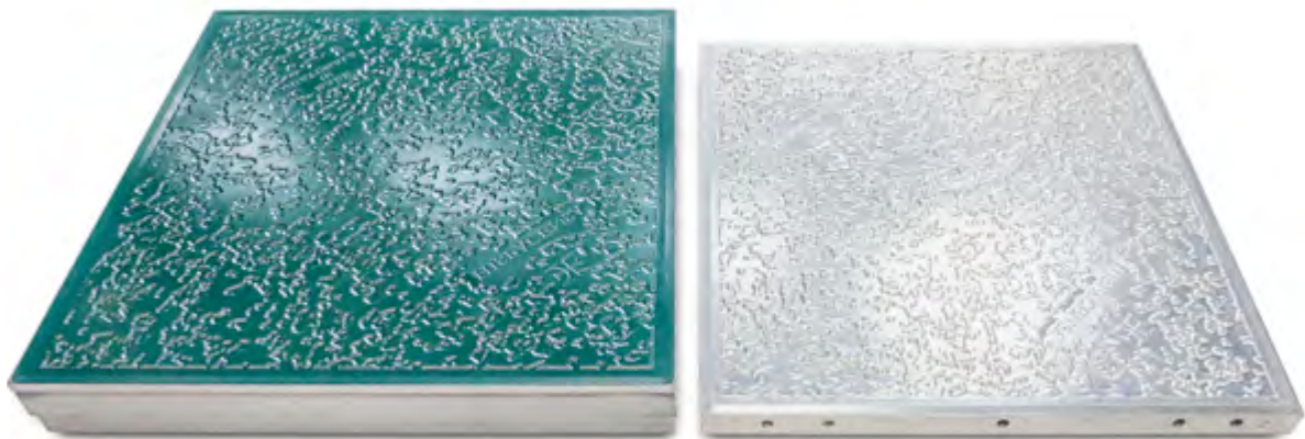
Figure 2.27. Relief de dos sur l'empreinte en aluminium (à droite) et le poinçon correspondant (à gauche)
