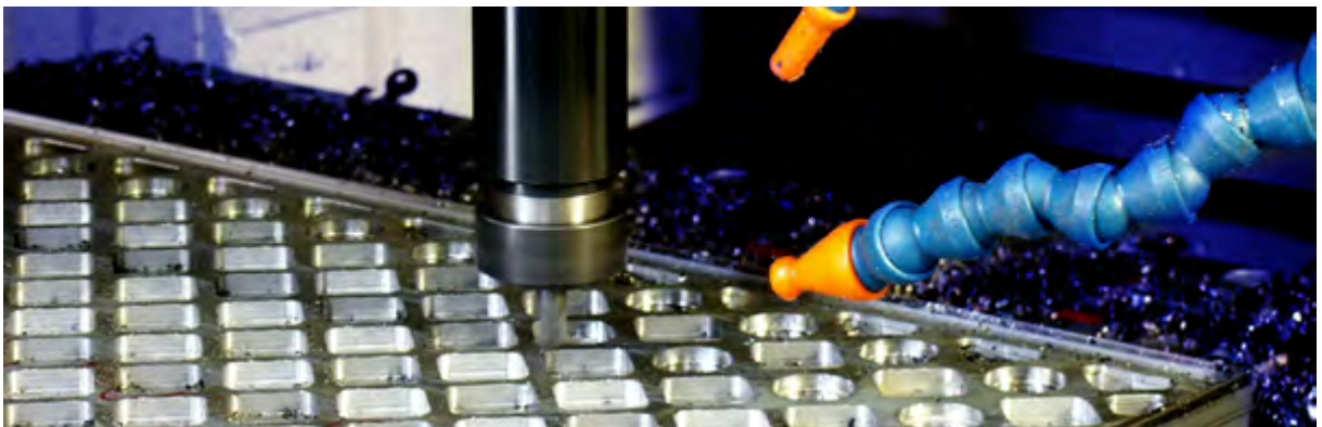
Figure 4.37. Usinage du système de compensation d'huile dans les poinçons isostatiques à grille de type MRPV
