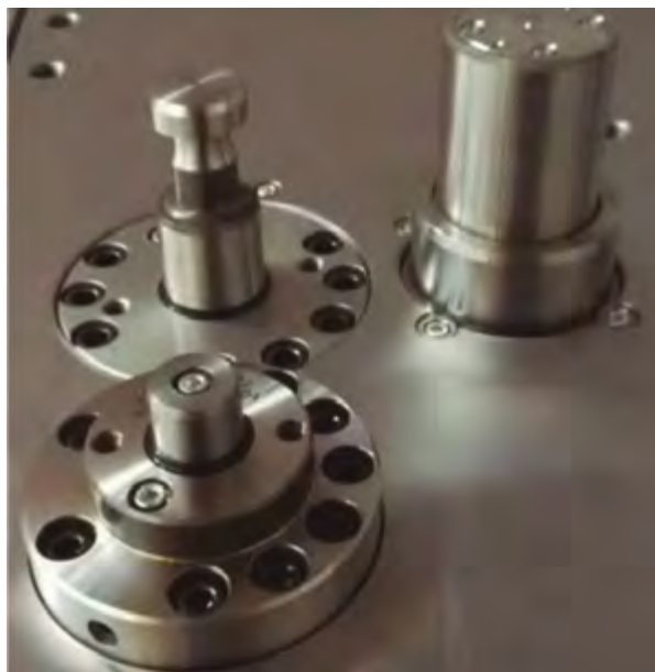
Figure 3.6. Détail du système de façonnage et d'extraction SPE 2+2® de SACMI (photo avec l'aimable autorisation de SACMI)
