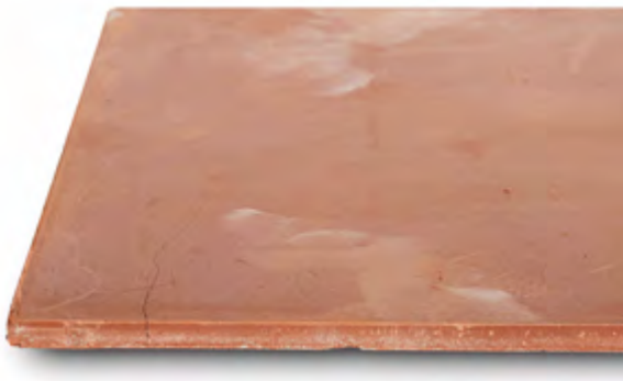
Figure 7.20. Fissure causée par un choc (dans les pièces insuffisamment compactées)
