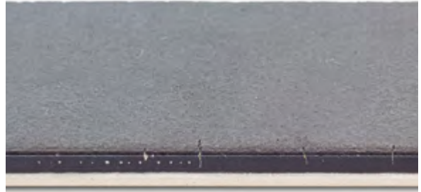
Figure 7.25. Peigne ou fissures de biseau
