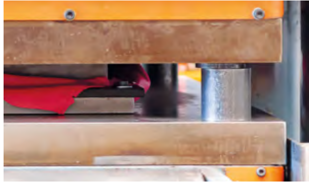
Figure 4.48. Disposition des butées ou « parallèles » dans la presse (détail)
