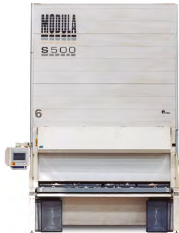
Figure 6.6. Module de stockage
