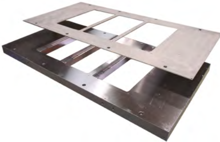
Figure 3.20. Plaque d'usure prête à être vissée sur la matrice
