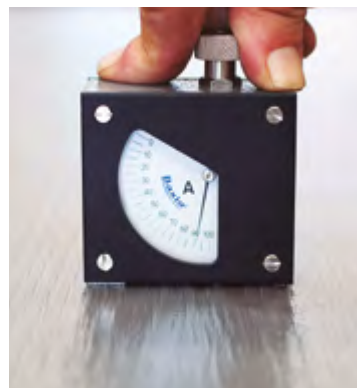
Figure VIII. 1. Contrôle de la dureté Shore A
