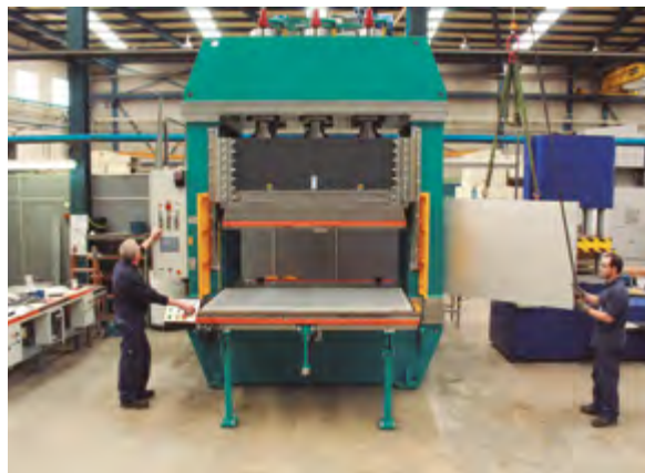
Figure 4.41. Presse à six pistons pour l'application de caoutchouc sur des poinçons de grand format
