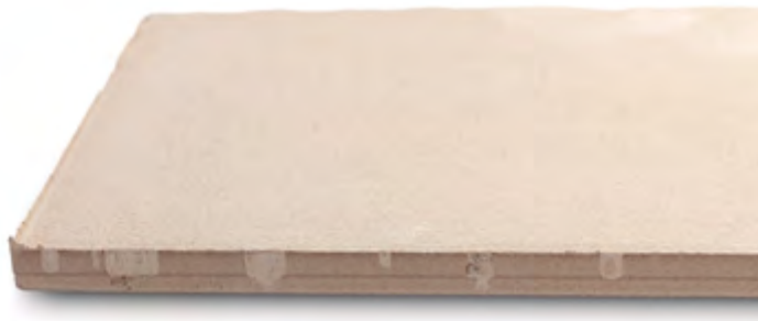
Figure 7.19. Frottements latéraux causés par un moule décentré
