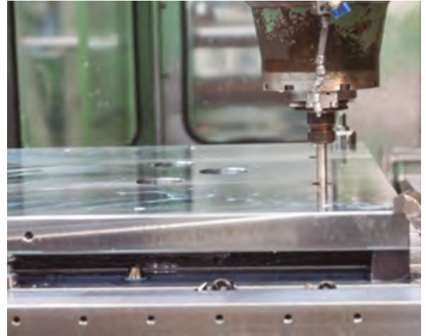
Figura 4.8. Fresado de desbaste de una placa salvabanco.
