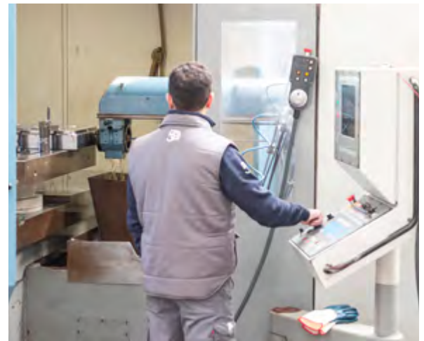
Figura 4.9. Taladrado de la placa salvabanco con taladradora de control numérico.
