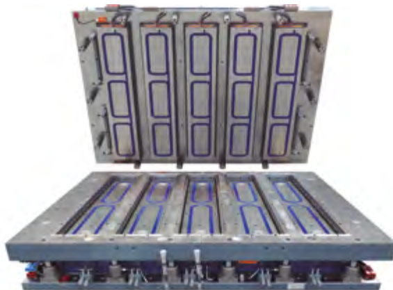
Figura 5.17. Molde espejo penetrante.
