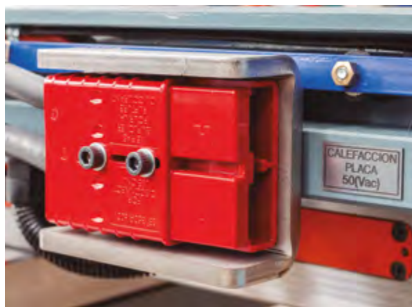
Figura 3.66. Conectores rápidos en una placa superior.
