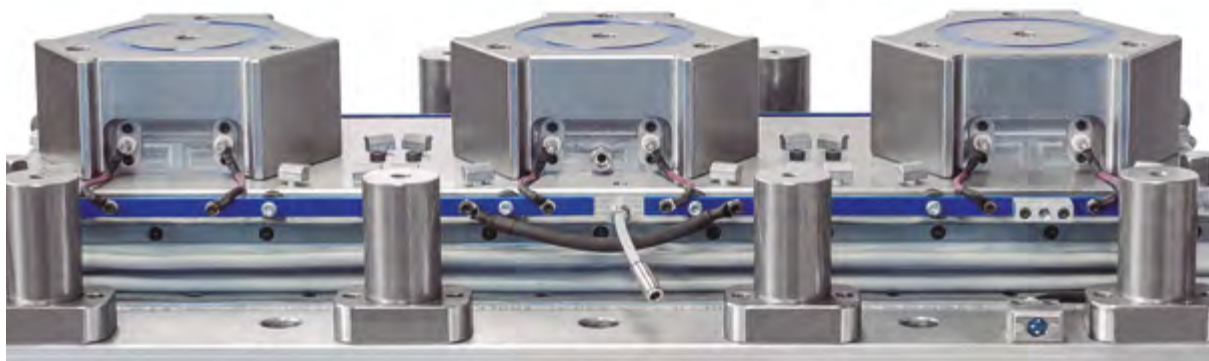
Figura 3.10. “Bloquetos” con bobina magnética.
