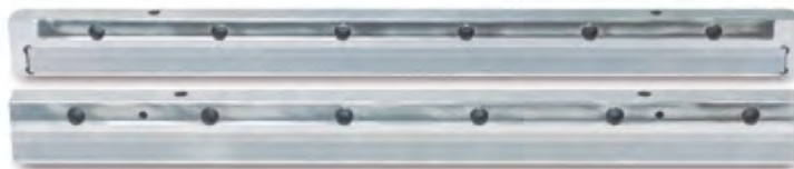
Figura 3.24. Cuchillas fijas con inserto de carburo de tungsteno.
