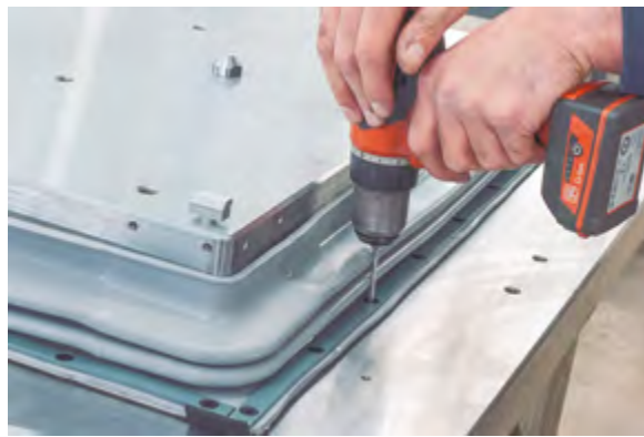
Figura 3.18. Montaje del fuelle de silicona.
