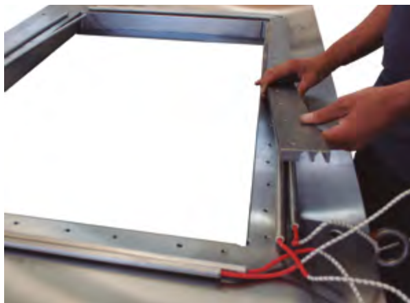
Figura 3.63. Resistencias calefactoras perimetrales en L.
