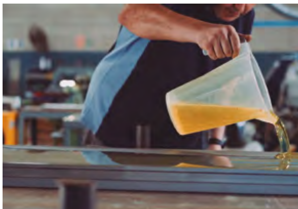
Figura 4.40. Vertido de la goma líquida en un punzón.
