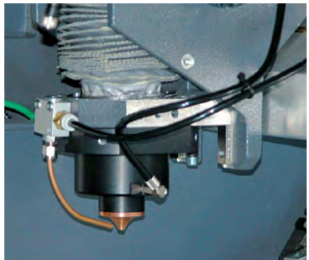
Figura 2.33. Boquilla de grabadora láser (fotografía cortesía de CIELLE)
