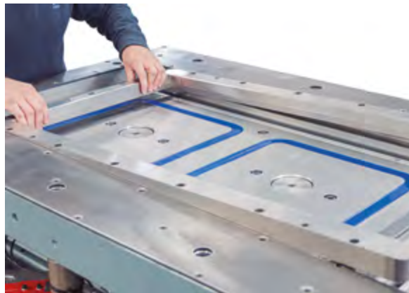
Figura 6.9. Cambio de cuchillas fuera de la propia prensa.
