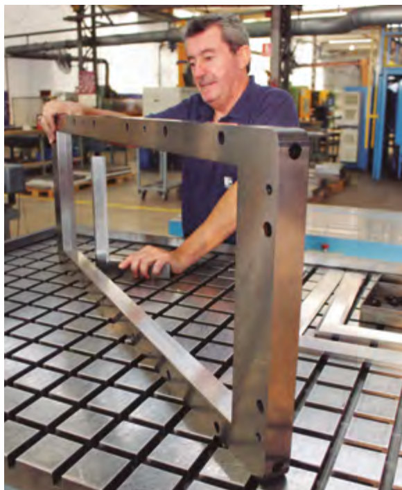
Figura 4.17. Cuchillas para una salida de 31 x 90
