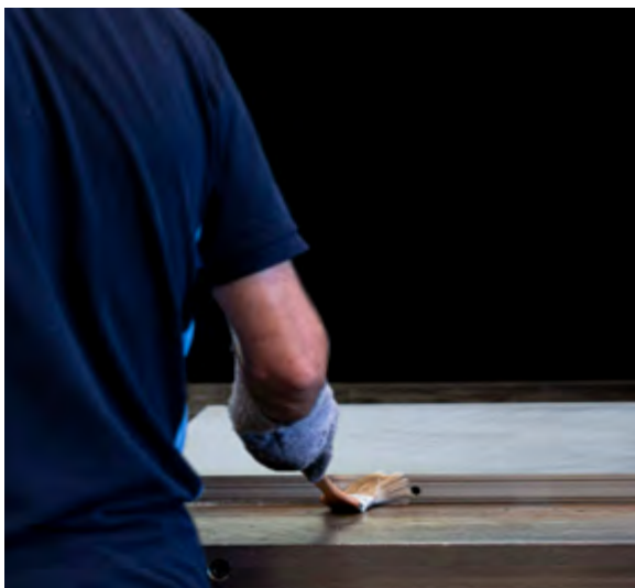
Figura 4.39. Aplicación de desmoldante en laterales del punzón.
