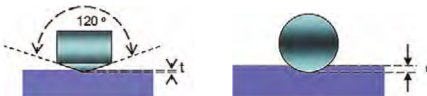
Figura III.4. Ensayo de dureza Rockwell (esquema).
