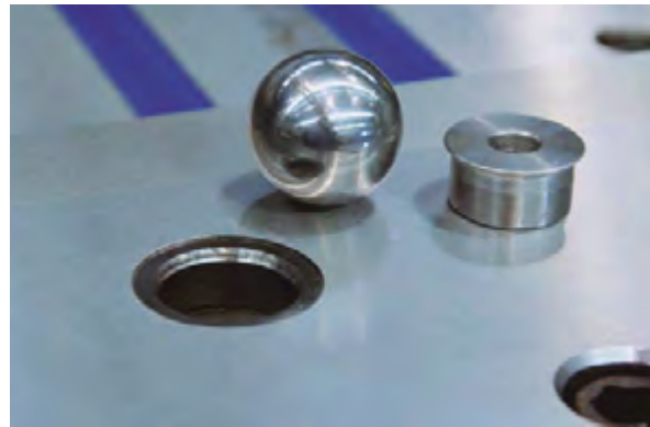
Figura 5.16. Sistema de centrado del doble molde.
