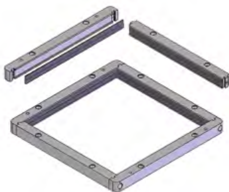
Figura 3.34. Esquema de la lámina de carburo de tungsteno insertada en una cuchilla y montaje de las cuchillas reforzadas
