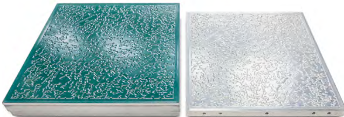
Figura 2.27. Relieve de dorso en la plantilla de aluminio (derecha) y el punzón correspondiente (izquierda)
