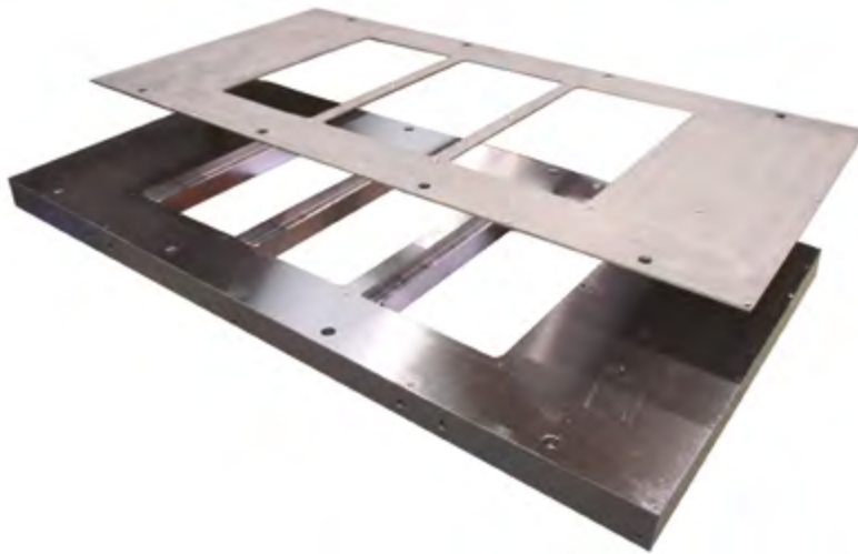
Figura 3.20. Chapa antidesgaste preparada para ser atornillada sobre la matriz.
