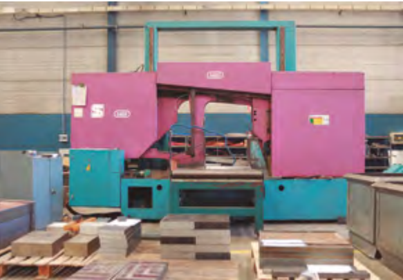
Figura 4.33. Corte de las planchas de acero en bruto con sierra.
