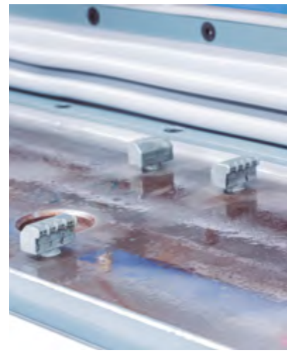
Figura 3.16. Disposición de los sopladores en el perímetro de la placa salvabanco.
