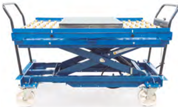
Figura 6.13. Carro hidráulico manual para el cambio de punzones.
