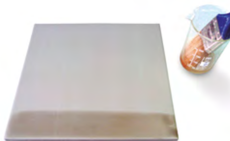
Figura 7.21. Procedimiento de detección de grietas a la salida del secadero
