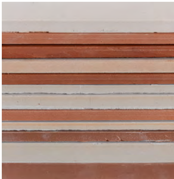
Figura 2.3. Secciones de baldosas con diferentes espesores
