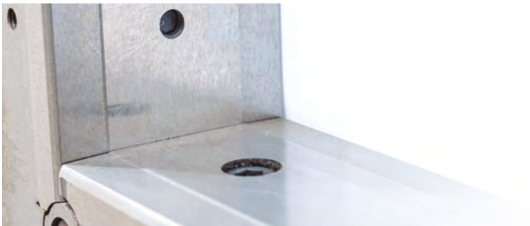
Figura 3.27. Cuchillas simétricas reversibles (detalle).
