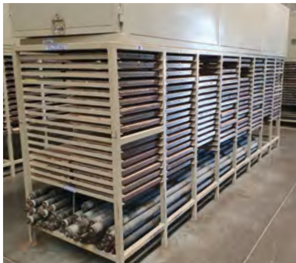
Figura 6.5. Instalaciones de almacenamiento de punzones.
