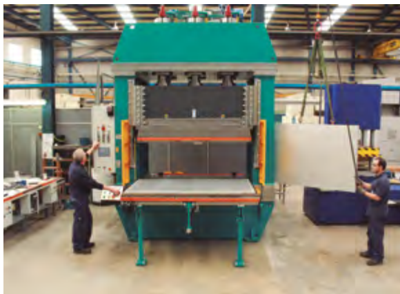
Figura 4.41. Prensa de seis pistones para aplicación de gomas a punzones de gran formato.
