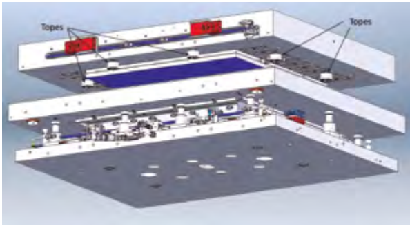
Figura 5.19. Molde espejo penetrante con topes.
