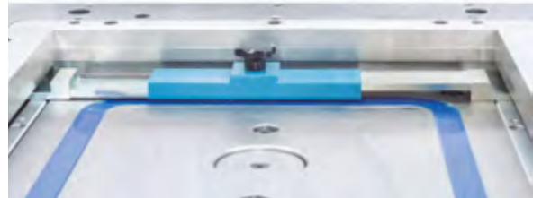
Figura 6.8. Extracción de cuchillas extraíbles.
