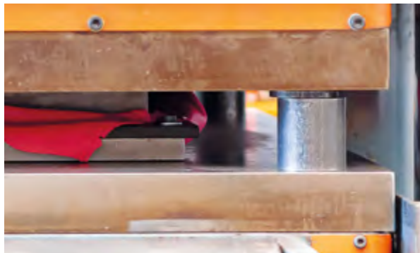
Figura 4.48. Disposición de los topes o "paralelas" en la prensa (detalle).
