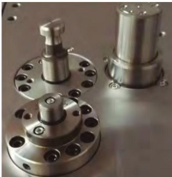
Figura 3.6. Detalle del sistema de conformado y extracción SPE 2+2® de SACMI. Fotografía cortesía SACMI.
