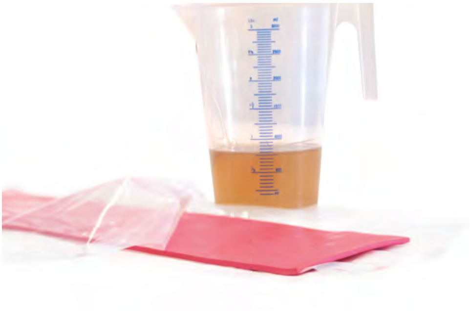
Figura 4.4 Diferentes tipos de gomas para recubrimiento de punzones.
