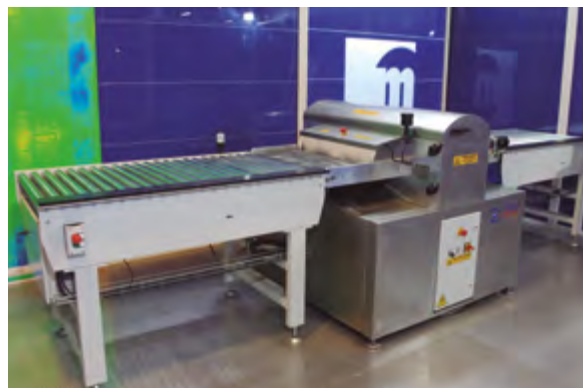
Figura IV.1. Equipo de medida de la densidad aparente por absorción de rayos X.
