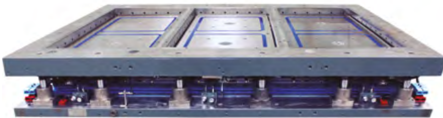
Figura 3.57. Molde de conformado inferior (doble molde)
