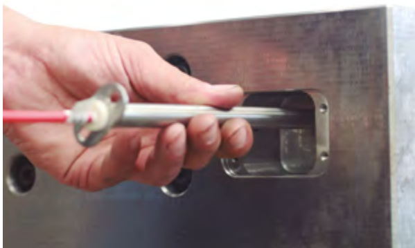
Figura 3.62. Resistencias calefactoras tubulares.
