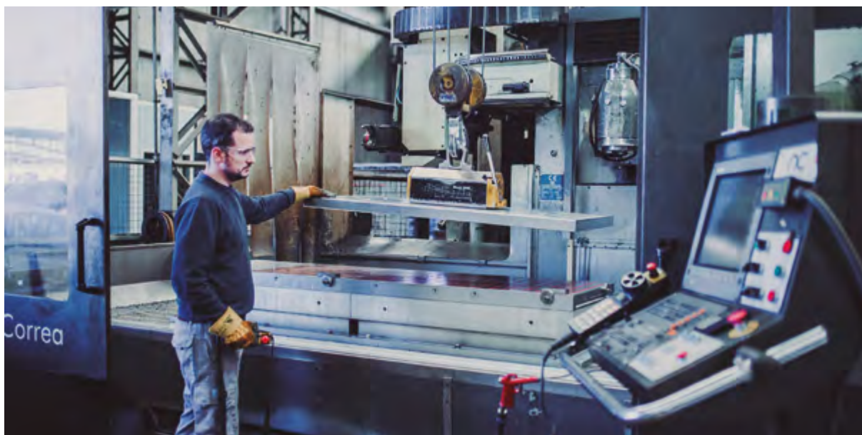
Figura 6.12. Levantamiento y manejo de grandes cargas con ayuda de polipasto e imanes.
