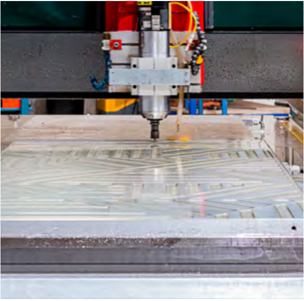
Figura 2.30. Mecanizado del relieve mediante fresadora sobre plantilla de aluminio
