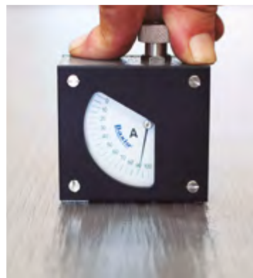
Figura VIII.1. Control de dureza Shore A.
