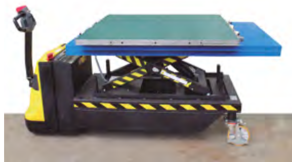
Figura 6.14. Carro hidráulico manual para el cambio de punzones.
